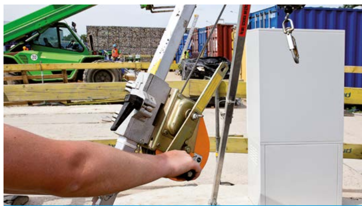
Urządzenie umożliwiające ewakuację nieprzytomnego pracownika.
