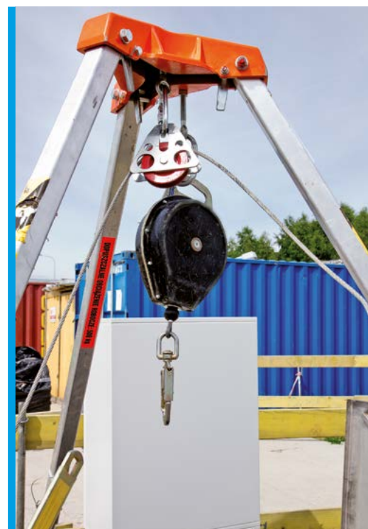
Urządzenie umożliwiające ewakuację nieprzytomnego pracownika.
