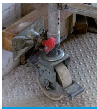
Hamulec rusztowania przejezdnego.
